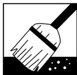
Les surfaces qui recevront le ciment colle doivent être sèches, solides et exemptes de tout produit (cire, scellant, etc.) qui pourrait nuire à l'adhérence (conformément aux standards de l'industrie tel que stipulé par l'ACTTM et le TCA).
