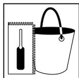
Appliquer avec une truelle plate en acier et lisser la surface jusqu'à l'obtention du fini désiré.
