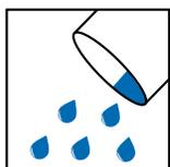
Utiliser un seau propre. Verser la quantité d'eau requise et y ajouter la poudre à colmater en brassant lentement. Il est préférable d'utiliser l'eau à la température de la pièce. Bien mélanger le contenu du sac à sec avant de délayer en petites quantités.
