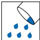
Utiliser un seau propre. Verser la quantité de liquide requise et y ajouter la poudre à colmater en brassant lentement. Il est préférable d'utiliser l'eau à la température de la pièce. Bien mélanger le contenu du sac à sec avant de délayer en petites quantités.
