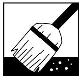
Les surfaces qui recevront le ciment colle doivent être sèches, solides et exemptes de tout produit (cire, scellant, etc.) qui pourrait nuire à l'adhérence (conformément aux standards de l'industrie tel que stipulé par l'ACTTM et le TCA).
