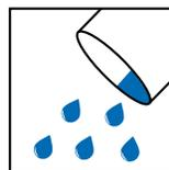
Dans un contenant propre, ajouter MULTIFLEX à l'eau tout en mélangeant lentement jusqu'à l'obtention d'une pâte de consistance uniforme et crémeuse. Laisser reposer 10 minutes et mélanger à nouveau. Si vous utilisez un mélangeur, assurez-vous de mélanger à basse vitesse de façon à ne pas emprisonner d'air à l'intérieur du mélange. Ne pas rajouter d'eau ou de poudre après avoir remélangé. Le matériel peut épaissir légèrement durant l'utilisation, le mélanger à nouveau sans ajouter d'eau.
