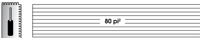
1/4 X 3/8 - Pour les tuiles jusqu'à 16" X 16" (400 mm X 400 mm)
